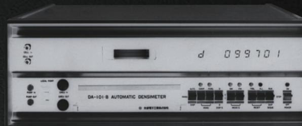
国産初の振動式密度比重計「DA-101B」
