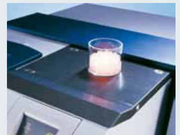
拡散反射測定積分球ユニット 固体・ペースト及び不均一な試料用
