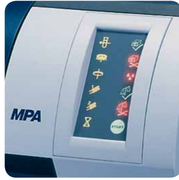
正面ディスプレイには装置の状態と測定が正常に行われたかどうかが表示されます。
